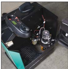
Uchylona obudowa zapewniająca swobodny dostęp do elementów serwisowych
